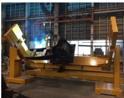
溶接ロボット
