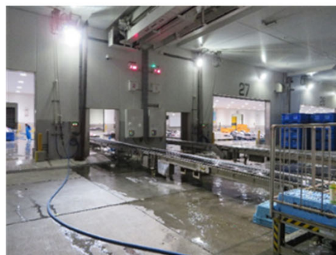
荷捌き施設の天井に配置したクレーン （岸壁に陸揚げした後、ベルトコンベアで場内へ搬入）
