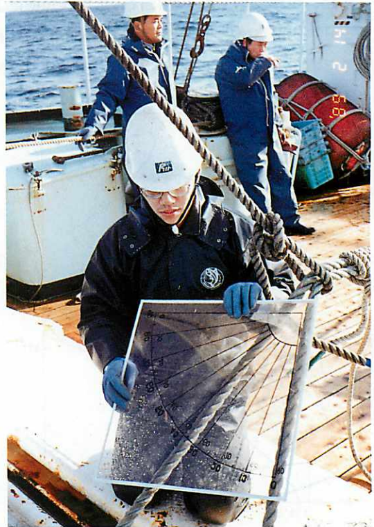
図7 船尾での曳網交差角度の測定
