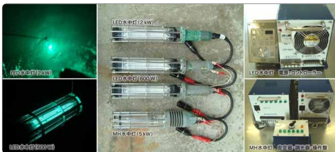
図2 点灯時のLED水中灯(左)、各種水中灯(中央)および電源・安定器・操作盤(右)
