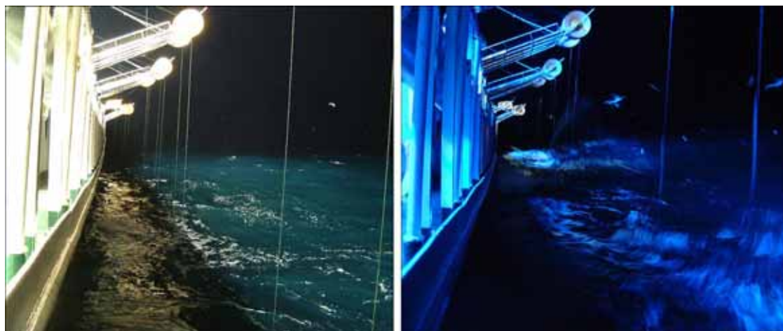
図29 MH灯(左)およびLED灯(右)点灯時の右舷側の様子
