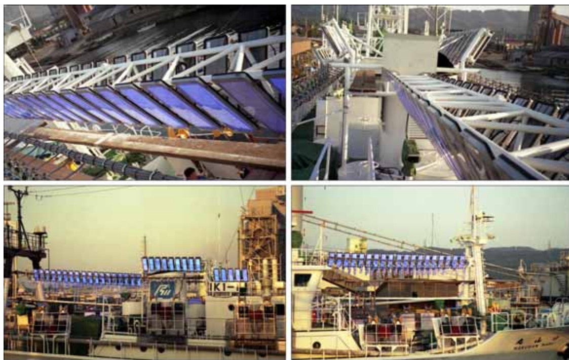
図3 調査船白山丸へのLED灯パネルの設置
