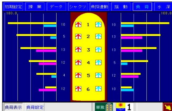
図2 操作盤に表示された釣機毎の漁獲状況
