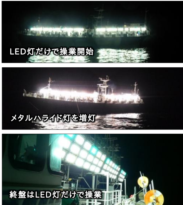
図 LED灯を用いた操業例
