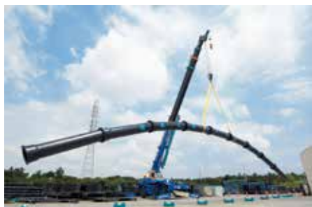
送水管の離脱防止テスト
