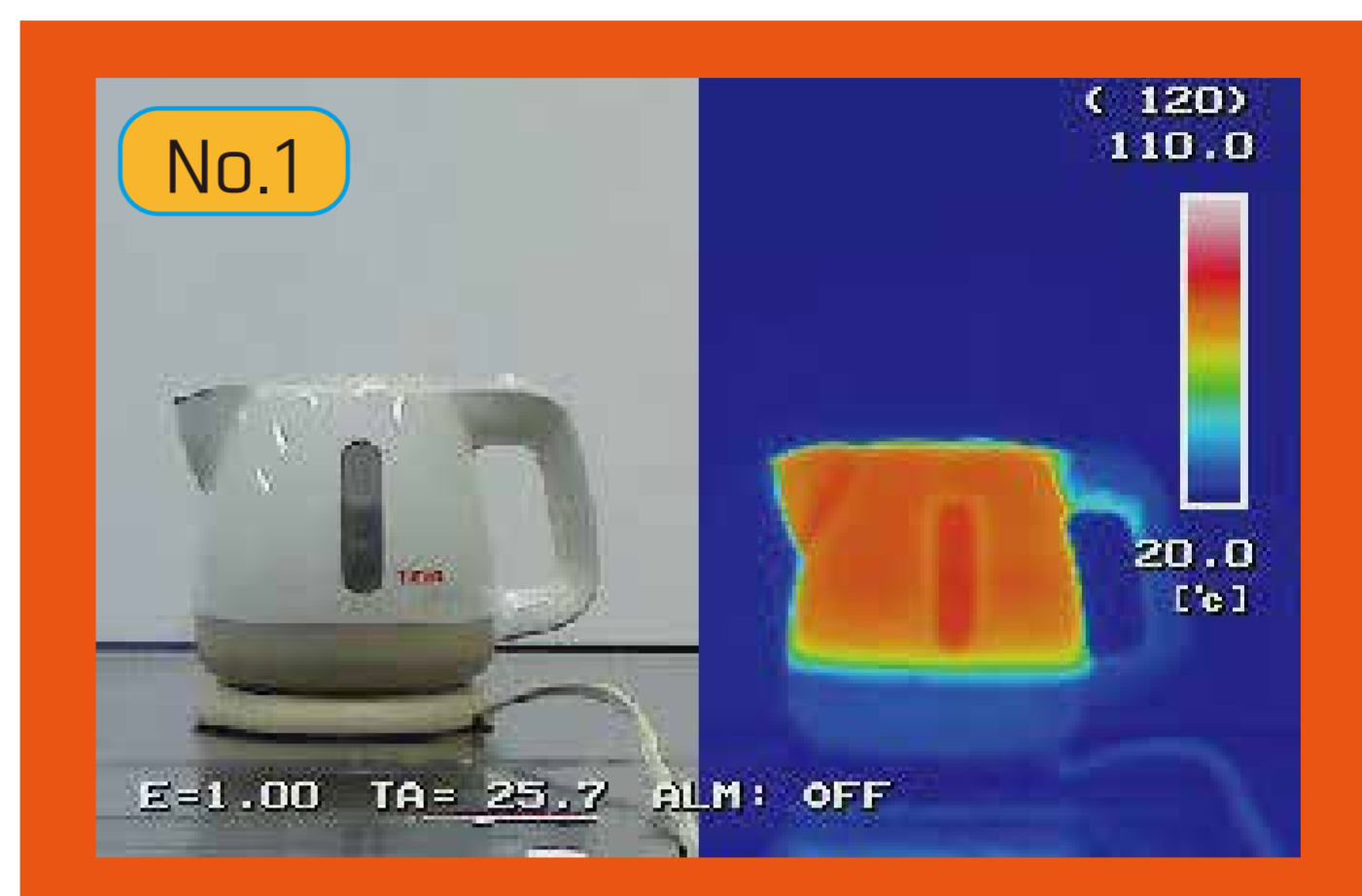
沸騰直後の電気ケトル温度分布例
