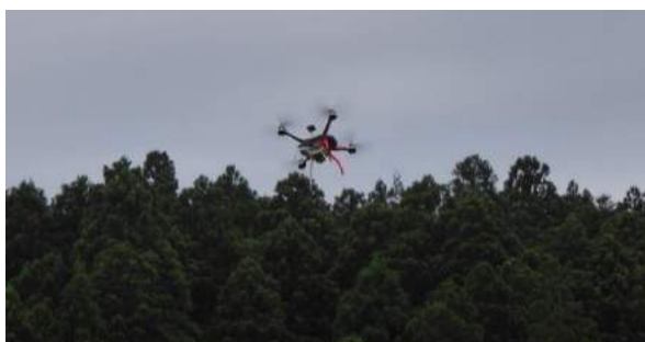
ドローンによる森林資源量の計測
