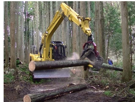
ICT高性能林業機械による丸太計測の自動化や仕分け等の効率化
