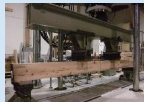
平角材の強度試験
