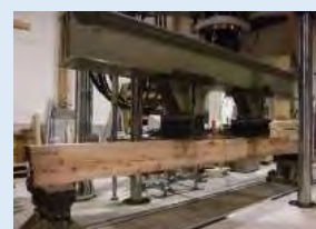
平角材の強度試験
