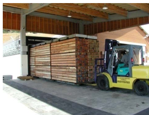
高温セット法による人工乾燥
