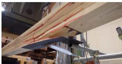
写真3 部分補強集成材の破壊状況
