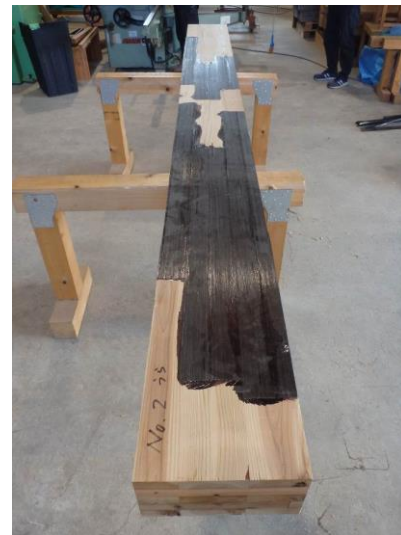
写真2 炭素繊維で部分補強したCLT（裏面）
