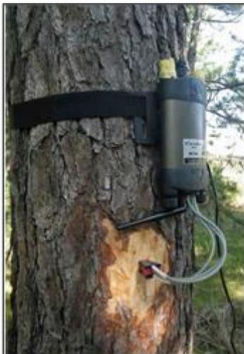
写真2 樹液流速器(SFM1)の設置図
