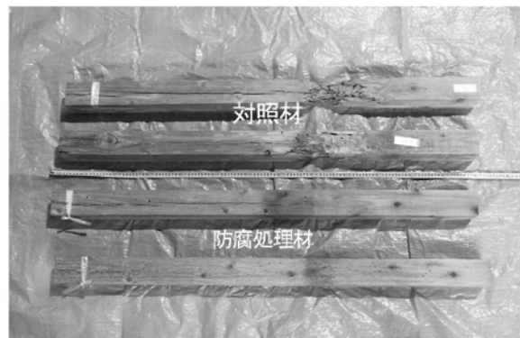
写真-1 曝露後8年経過した試験体
