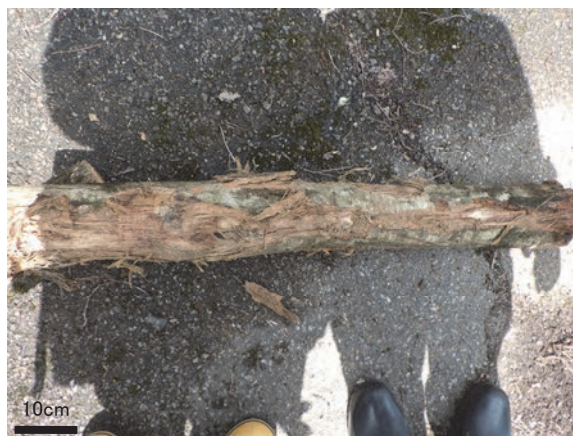
図-5. 全体にわたって樹皮の剥がれ（傷甚大）
