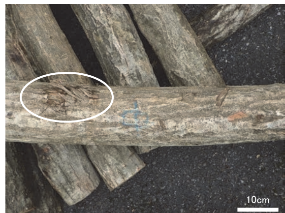
図-2. グラップルによる傷 (傷中)
