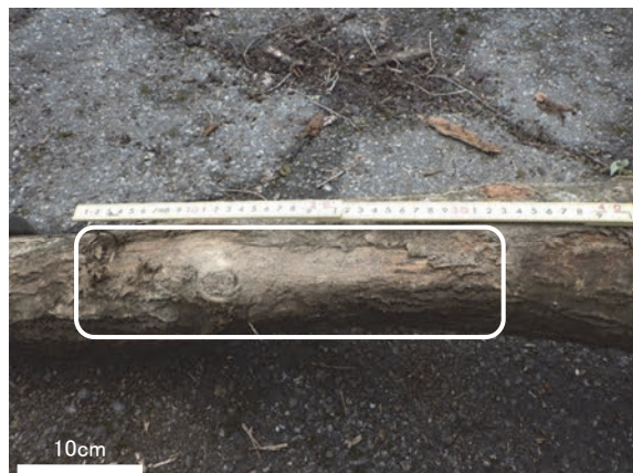
図-3. 引きずった際の皮向け（傷大）
