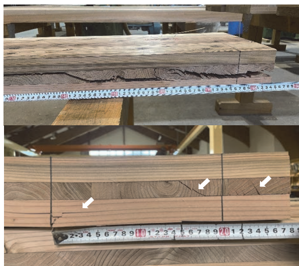
図-8. 破壊の様子（上：曲げ試験，下：せん断試験）
