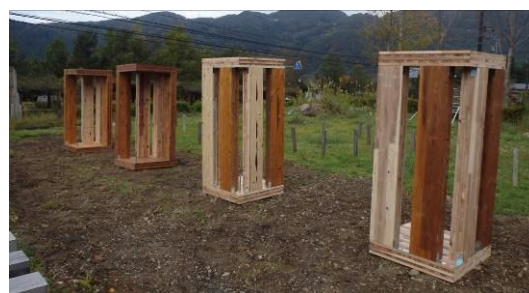
写真—1 暴露状況 (濃色に見えるのが塗装部材)
