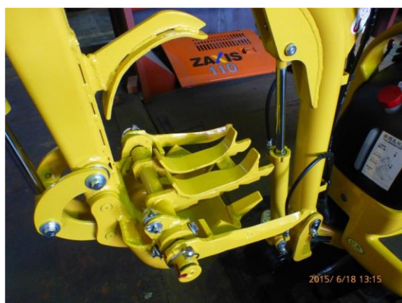
図-3 地かき用に加工したバケット 両端の2本が根切用の爪、中央は受け皿
