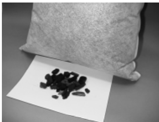
写真2 製材端材利用の木炭（床下調湿材）
