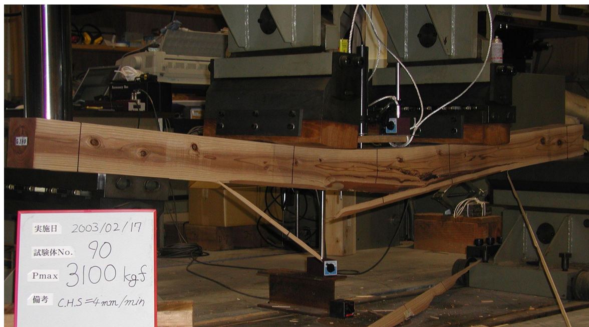
4寸角柱材の曲げ試験
