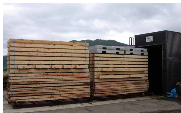
写真 3 乾燥試験の様子 (おもしを載せて乾燥 (右側))
