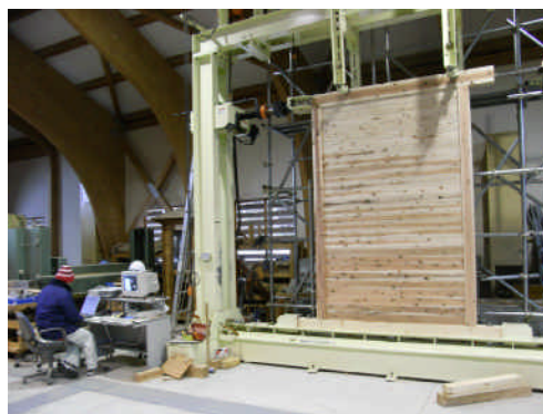
ウッドブロック工法のせん断試験
