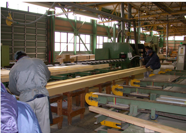
化粧単板の接着現場
