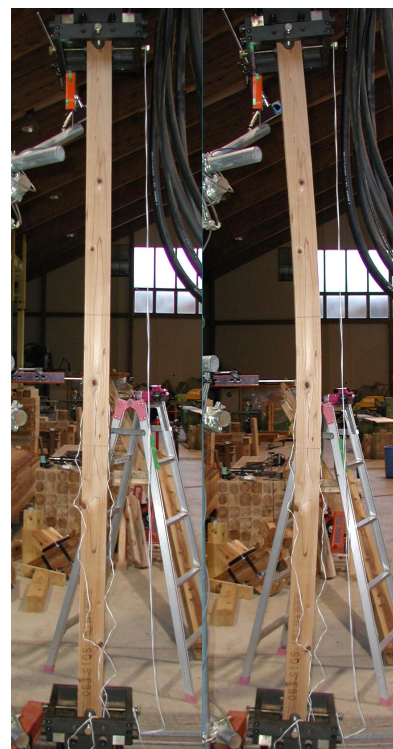
試験前 試験後 写真 柱の縦圧縮試験
