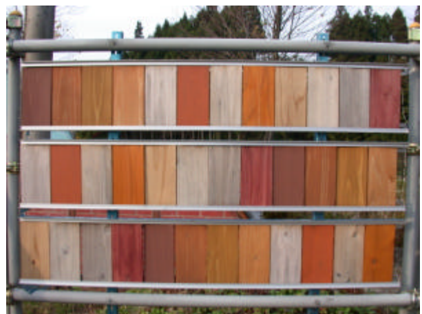
曝露1年経過時の状況 (2004.11)
