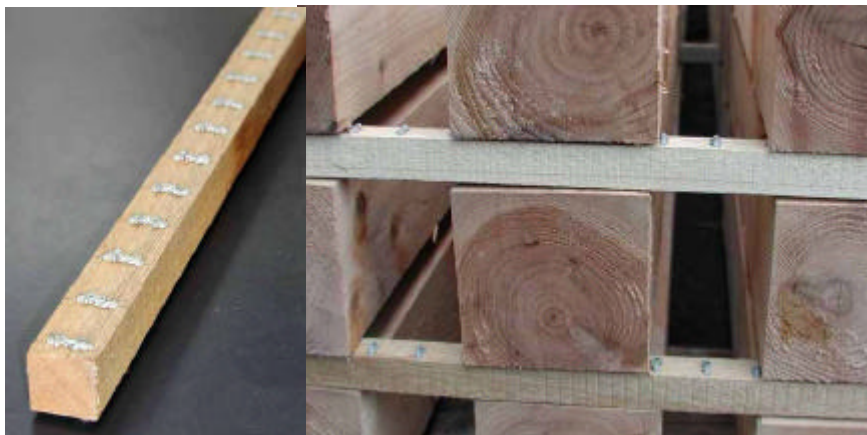
写真 左：改良栈木、右：改良栈木を用いた栈積みの様子
