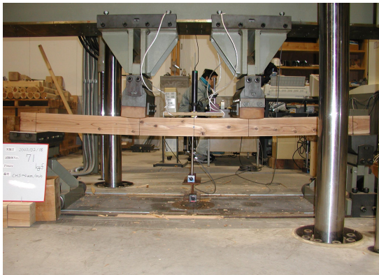
乾燥材の曲げ強度試験
