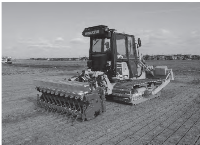
農業ブルドーザによる乾田V溝直播作業
