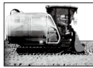
高性能コンバイン ・収量センサ付き
