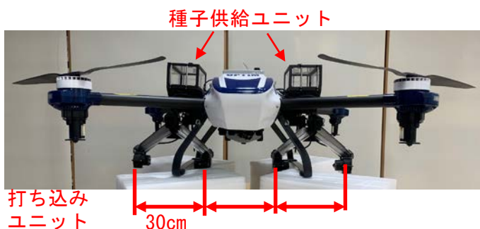
図1 ドローンに装着した播種機 (株式会社オプティム制作)
