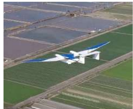
固定翼型ドローンによる広域調査の様子
