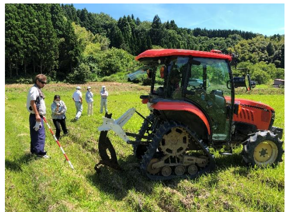
サブソイラーによる大麦圃場における排水対策のモデル実証
