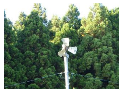
カキ園に設置された防霜ファン
