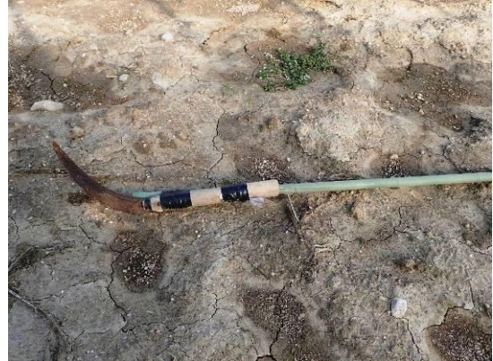
棒の先にガムテープで固定した鎌で ビニールを切る
