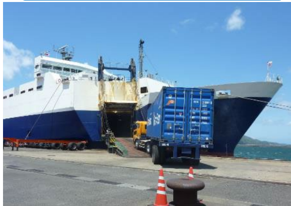
RORO船の荷役状況
