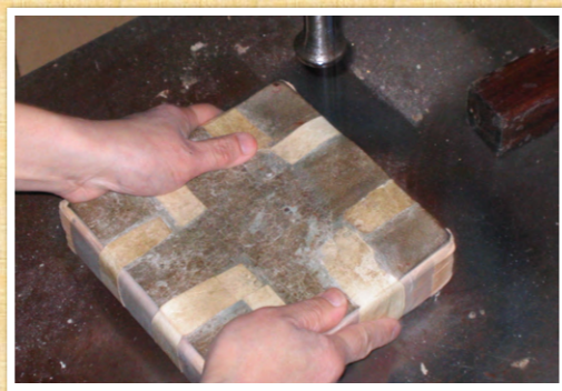
金箔を挟んだ紙の束を箔打機で打つ様子
