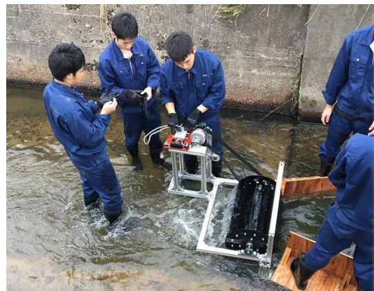
産業界等と連携した専門人材の育成事業「小水力発電機の実験」
