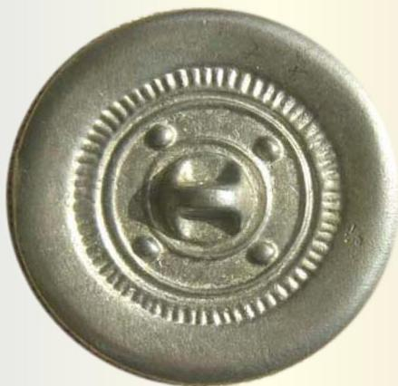
低融点合金を使った鑄造を見学し、小型の鏡を研磨して仕上げます。
