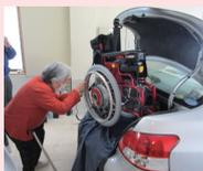
簡易型電動車椅子の車載装置
