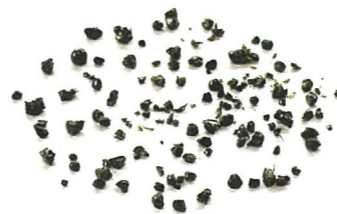
RDFの焼却で発生するスラグ
