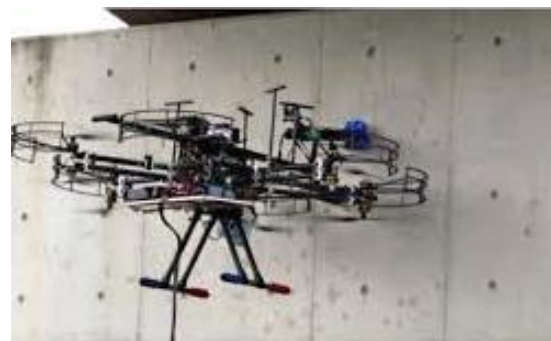
目視点検が困難な場所での ドローンを活用した点検
