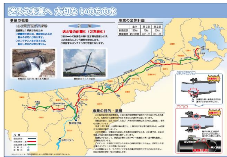
県水道用水の送水管耐震化事業
