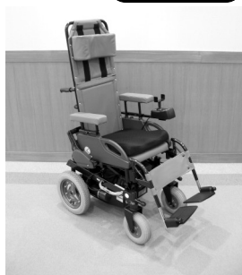
JIS 規格に定められている電動車いす。 最高速度 6km/h 連続走行距離 約 27km
