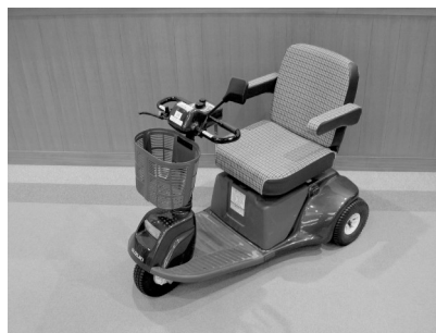
JIS 規格に定められているハンドル形電動車いす。タウンモビリティの新しい移動手段として普及している。道路交通法上は「車いす」となるため「歩行者」として扱われる。 最高速度 6km/h 連続走行距離 約 27km
