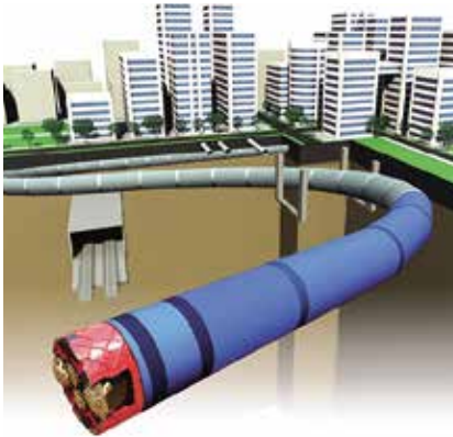
ベル工法(長距離曲線推進工法)
