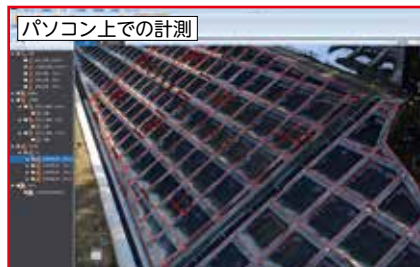
無人航空機で取得する3次元測量データを活用して、パソコン画面上で必要な寸法等を計測することにより、効率的で安全な施工管理ができます。
