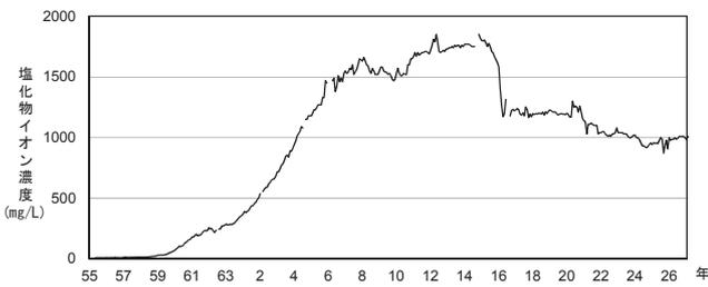
図5 能美市道林観測井の塩化物イオン濃度の経年変化（昭和56年～平成27年度）
