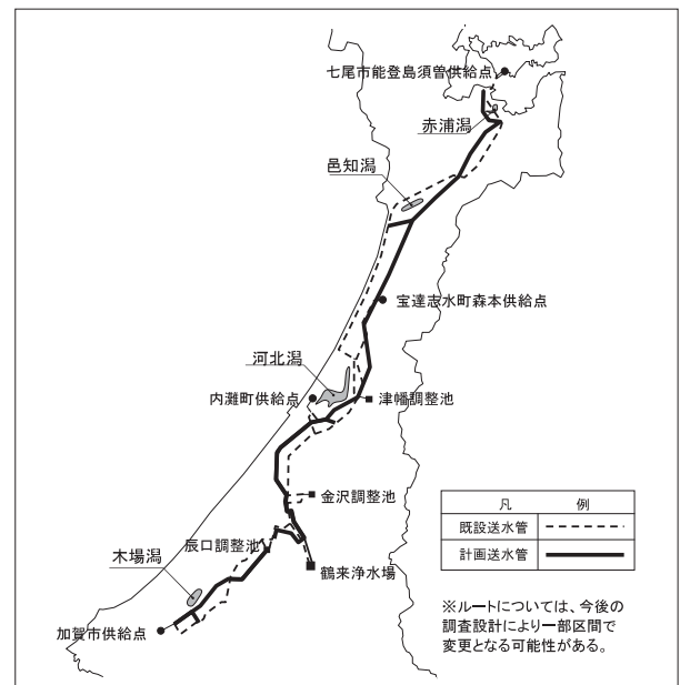
図11 県営水道の送水管耐震化事業
