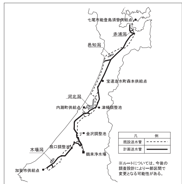
図11 県営水道の送水管耐震化事業
