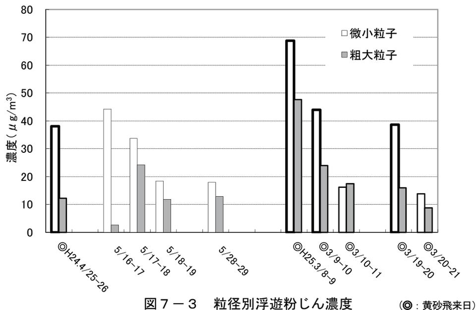
粉じん濃度は、微小粒子側（粒径  $2.5\mu\text{m}$  以下）が表 7-2 のとおり、非飛来日の平均値が  $29\mu\text{g}/\text{m}^3$  に対し、黄砂飛来日の平均値は  $37\mu\text{g}/\text{m}^3$  と 1.3 倍であった。また、粗大粒子側（粒径  $2.5\mu\text{m}$  以上）は、表 7-3 のとおり、非飛来日の平均値が  $13\mu\text{g}/\text{m}^3$  に対し、黄砂飛来日の平均値は  $21\mu\text{g}/\text{m}^3$  と 1.6 倍であった。
