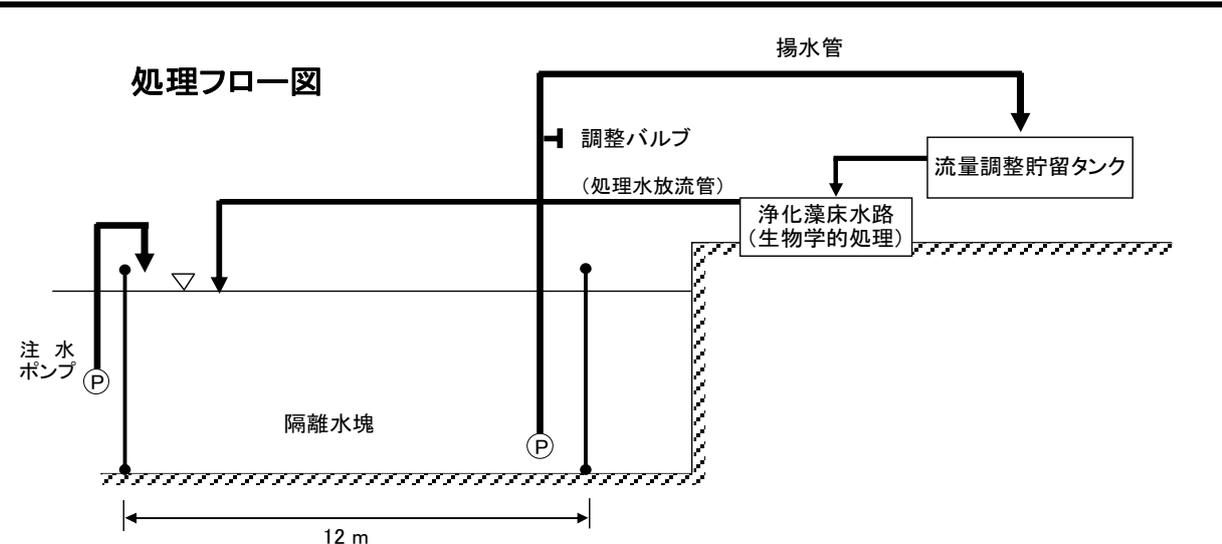
浄化藻床水路へ導水し、繊維状形態藻類の物理作用、生物作用によって、SS成分の濾過、栄養塩類の吸収を行う。また、水路の藻床には溶存酸素も増加し、水路の稼動と並行して藻床内の微生物作用によって有機物の分解・吸着が促進される。
