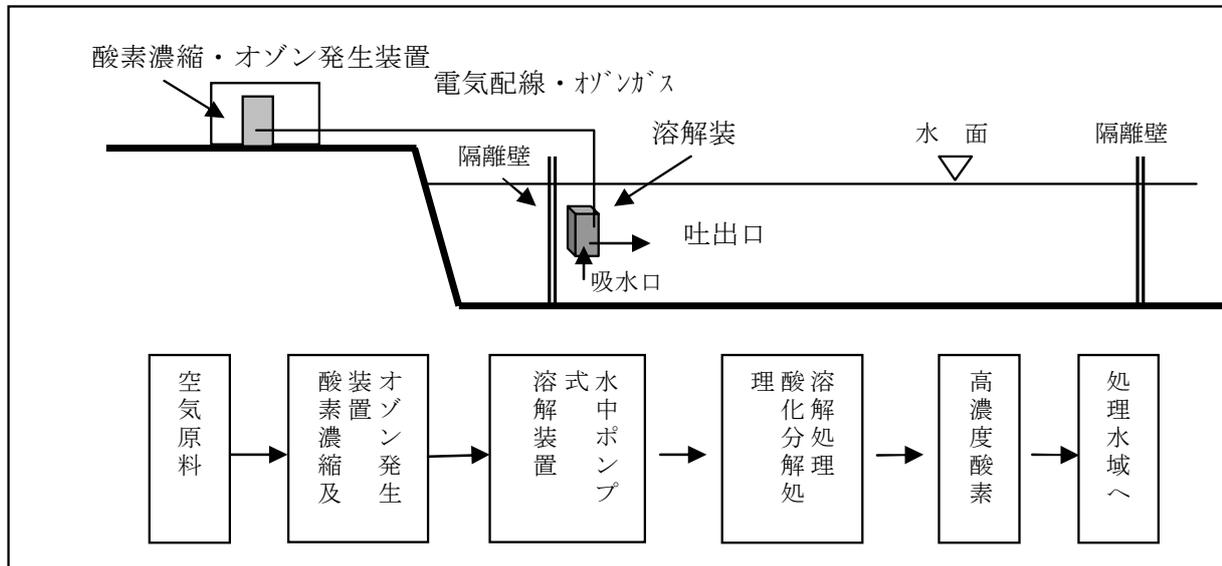
高効率の気液溶解装置を利用して処理水と濃縮酸素及びオゾンとを混合攪拌し、反応させる。処理水中の有機物はオゾンにより酸化分解され、生物分解を促進するとともに、濃縮酸素を処理水中に溶解させて、高濃度酸素水を処理水域に吐出し好気性環境を形成することで生物処理を促進する。
