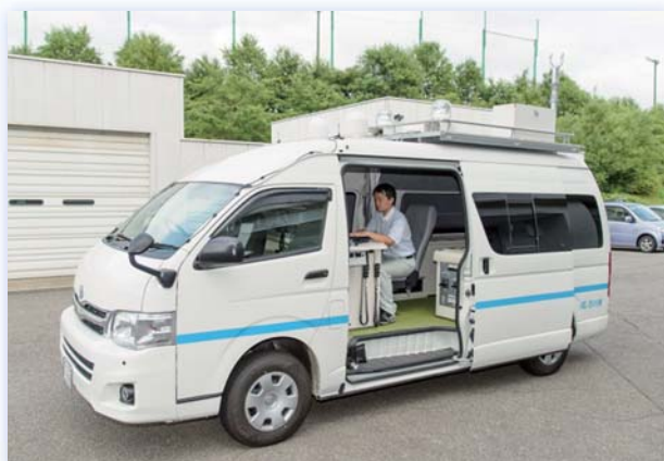
走行しながら放射線を測定する モニタリングカー
