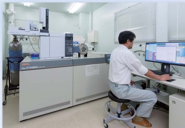
ダイオキシン類を解析する 高分解能ガスクロマトグラフ質量分析装置 (GC-MS)
